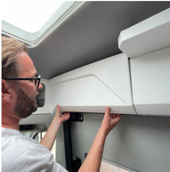
1. Entfernen der linken Verkleidung über Schiebetür, durch Abziehen der Klettverschlüsse. Erst unten, dann oben abheben.
