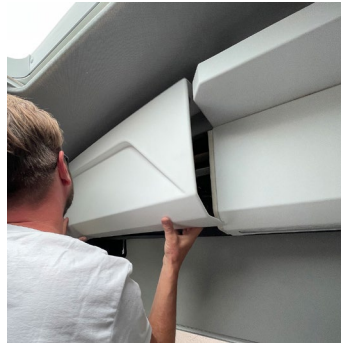
2. Aushängen der oberen Haken aus der Deckenverkleidung.
