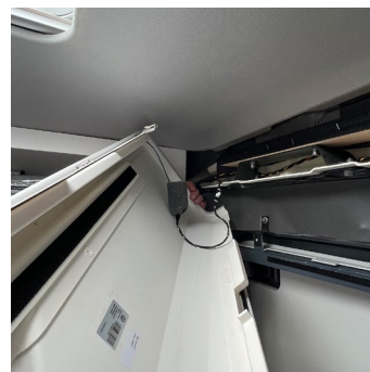
11. Jetzt wieder die linke Verkleidung richtig ansetzen.
