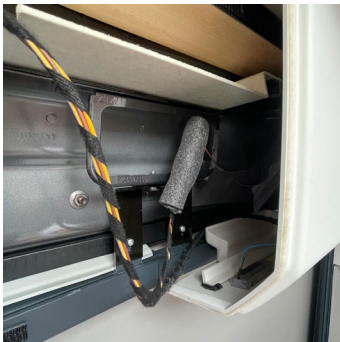
5. Unter der rechten Wandverkleidung findest du das Lichtmodul noch verkleidet. (Schaum/gelbe + rote Kabel)
